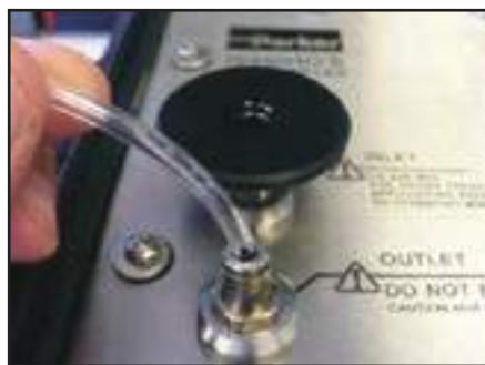
Conecte uma mangueira de SAÍDA (ø 4 mm)
